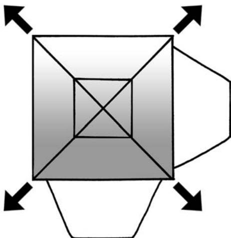
**D** Fixieren Sie nachfolgend alle vier Bodeneckpunkte an den Schlaufen mit Heringen (1) und ziehen Sie dabei die Bodenplane straff aus (2).
