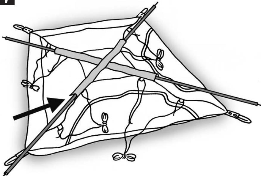
D Schieben Sie vorsichtig die beiden Stangen überkreuz durch die Stangenkanäle auf der Zeltmitte (1). Setzen Sie die Stangen unter Spannung, indem Sie die spitzen Stangenenden jeweils in die dafür vorgesehenen Ösen an den jeweiligen Bodeneckbändern stecken und bilden so eine Kreuzkuppel (2).
