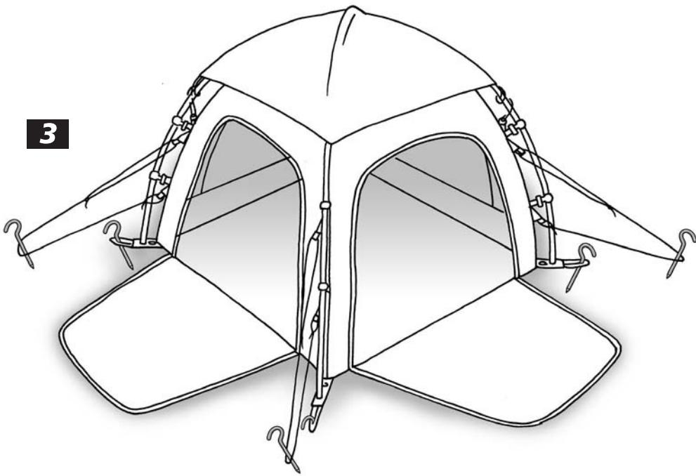
**F** Fixez ensuite avec des piquets les quatre coins du sol en utilisant les boucles (1) et ce faisant tirez jusqu'à ce que le tapis de sol soit bien tendu (2).
