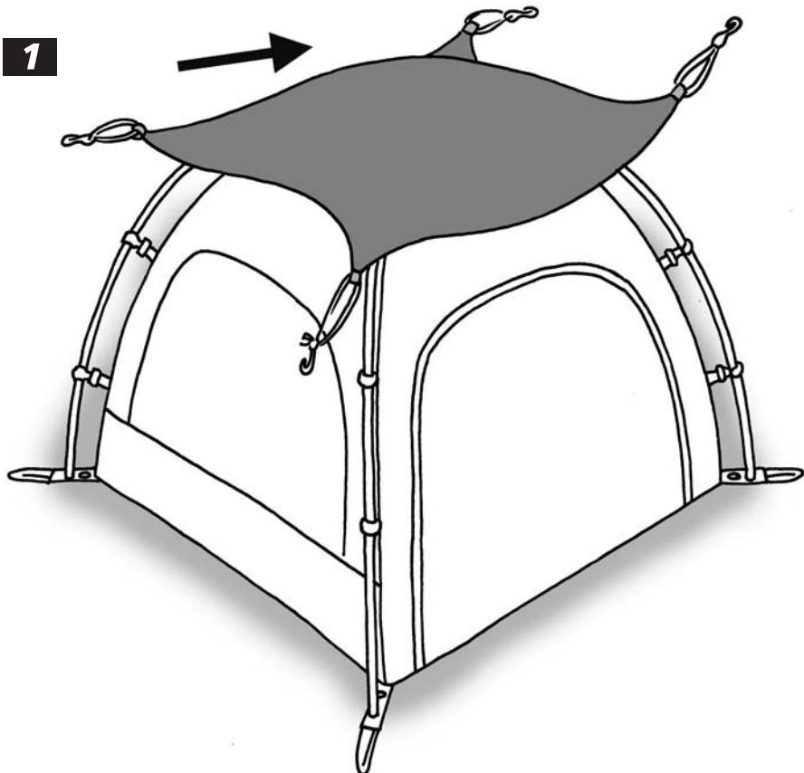
D Legen Sie die Dachplane über die Kreuzkuppel, so dass die elastischen Bänder sich an den Stangen ausrichten (1). Schlingen Sie die elastischen Bänder jeweils einmal um die Stange (2) und fixieren Sie den Kunststoffhaken in den Ringen an der Clip-Befestigung (3).
