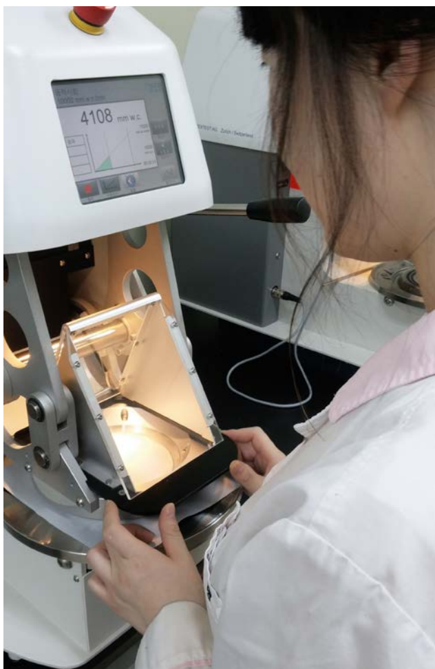
Im Hydrostatic-Tester überprüfen wir die Wasserdichtigkeit und ermitteln die maximale Wassersäule, die das Material aushält.
